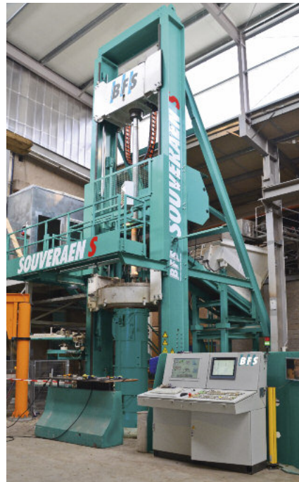
Wysokowydajna maszyna Souveraen do rur dla systemów kanalizacji i rur ciśnieniowych z płaszczem stalowym o średnicach DN 225 – DN 1800.
