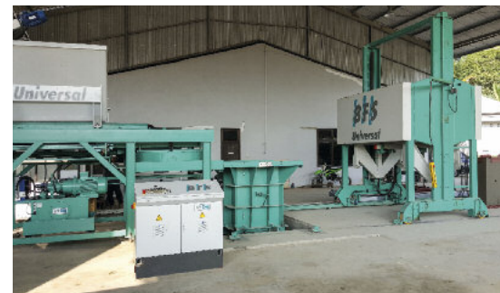
Maszyna Universal produkuje w Indonezji małe przepusty skrzynkowe i tzw. kanaty ściekowe w kształcie litery U.
