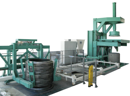
Produkcja elementów studzienek za pomocą maszyny Atlantic wraz z transportem podkładów dolnych.
