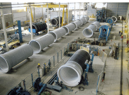
Produkcja sprężonych rur ciśnieniowych metodą zagęszczania przez wirowanie.
