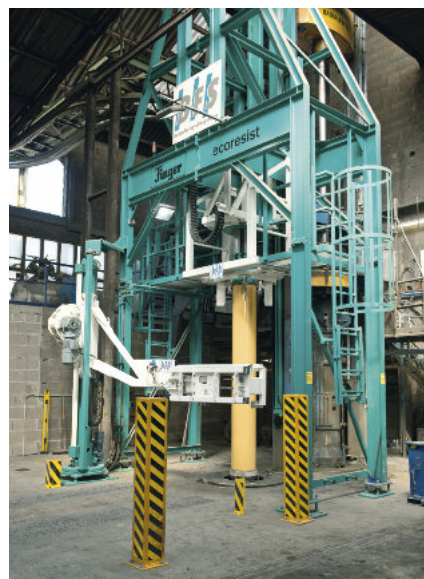
Innowacyjny system BFS - Ecoresist zapewnia wydajną produkcję rur betonowych z okładziną wewnętrzną.
