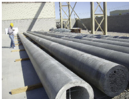
Sprężone pale wykonane w kompletnie wyposażonym zakładzie produkującym pale wirowane firmy BFS.
